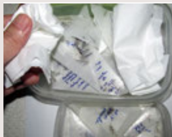
タッパーの空間をティッシュペーパーで内容物が動かない程度に「ふわり」と埋める。緩衝と吸湿も兼ねる
